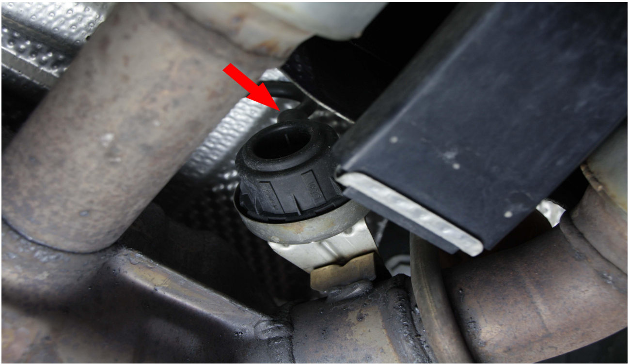
Unterdruckschlauch der Klappensteuerung abziehen
